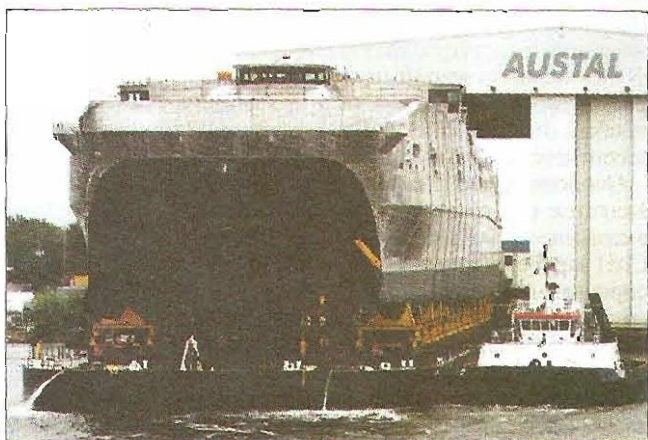
Судно обеспечения десантных операций типа JHSV на стапеле завода компании «Остал Ю-Эс-Эй»
