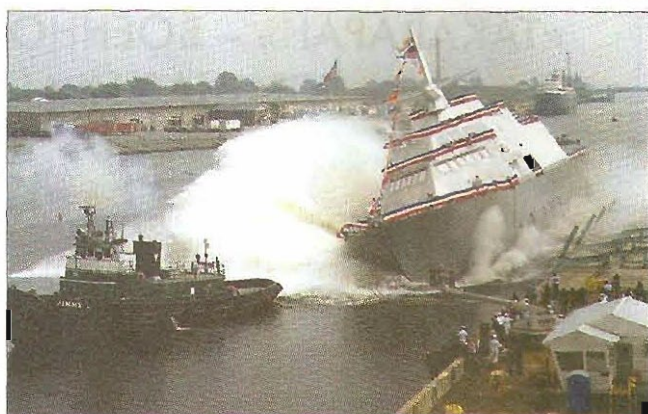
Спуск на воду корабля прибрежной морской зоны типа «Фридом» на заводе компании «Маринетт марин»
