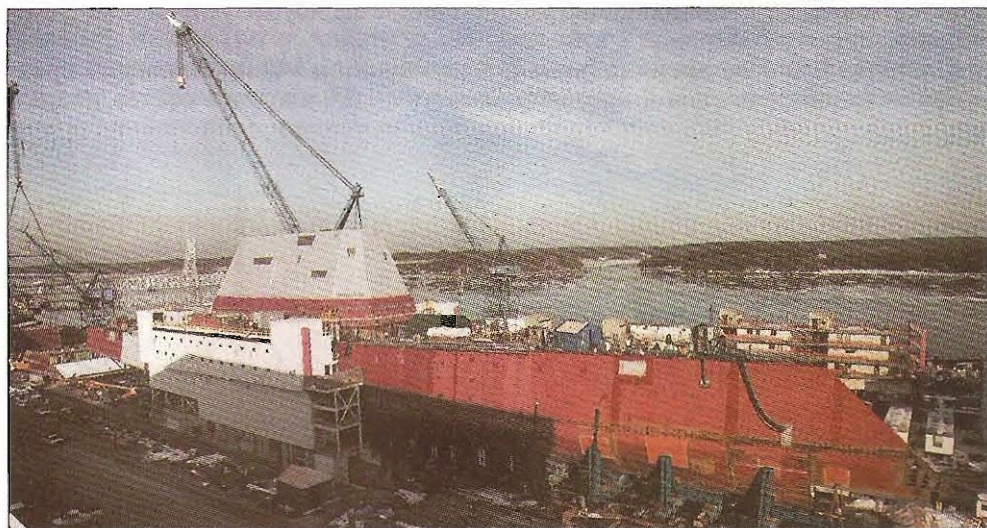
Строительство эсминца DDG-1000 «Замволт» на верфи компании «Бат айрон юркс»
